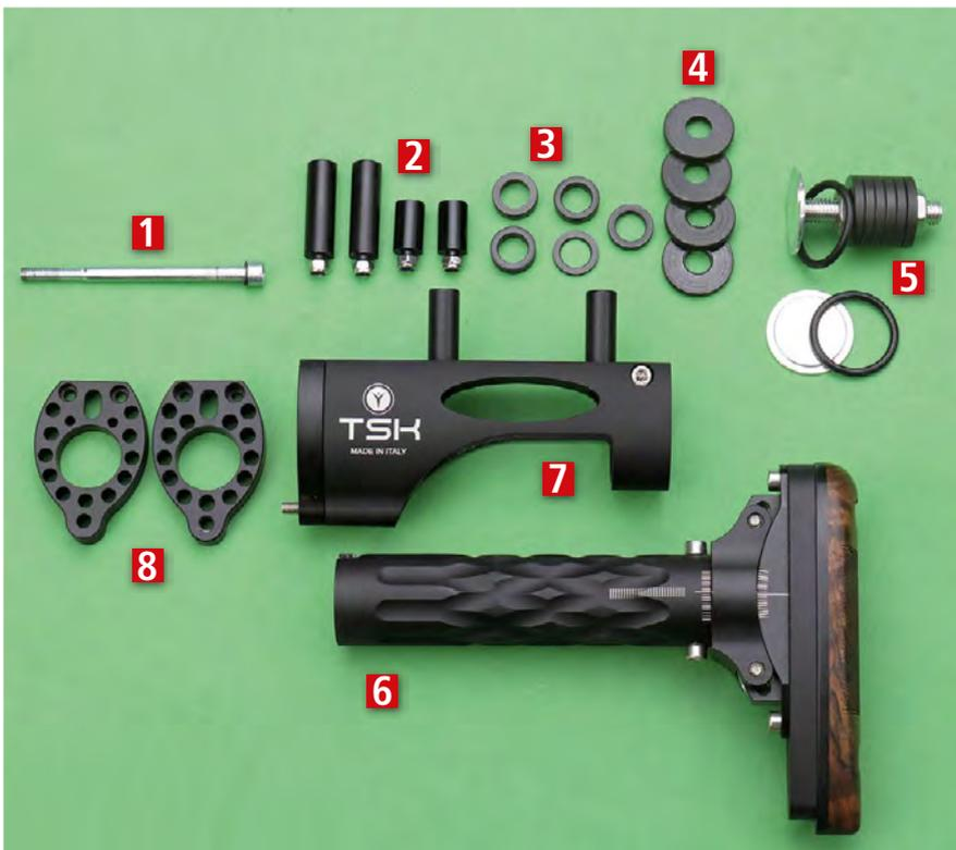
1: Schaftschraube zur Befestigung an der Basküle; 2: Stehbolzen für den Schaft Rücken in zwei Höhen; 3: Distanzringe zur Regulierung der Höhe des Schaft Rückens; 4: Balancer-Gewichte; 5: der Balancer mit mehreren montierten Gewichten; 6: 140-mm-Schaftrohr (hier: Skeet Super Light mit optionaler Holzkappe); 7: Schaftbrücke mit 28-mm-Stehbolzen; 8: Winkelausgleichsplatten Trap und Sporting.
